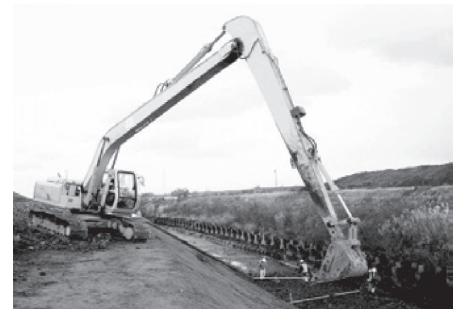
油圧掘削機ロングリーチ なめらかな法面が必要とされる改修 工事や水底の堆積物を取る浚渫工事に！
